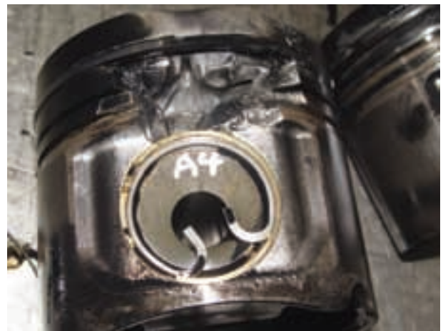
Şekil 6 Parçalanmış piston yan görünüşü
