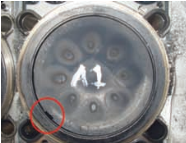
Şekil 3 Piston üst tablasında oluşan delik
