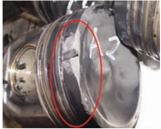
Şekil 4 Piston üst tablasında karıncalanma
