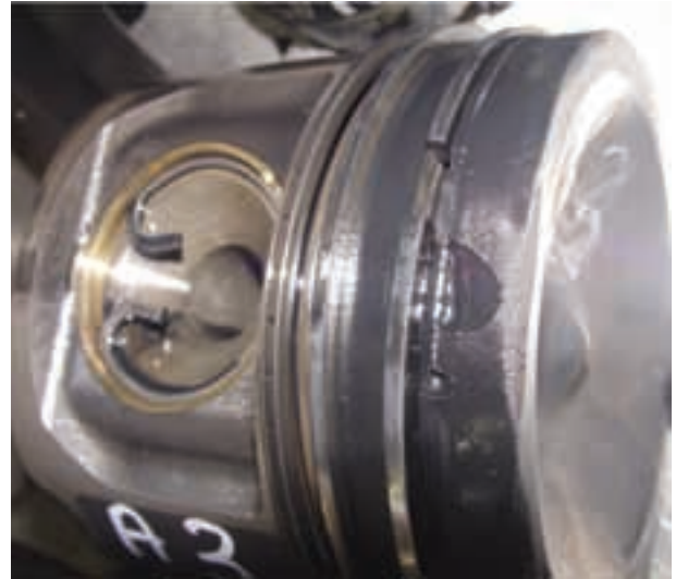
Şekil 5 Piston üst tablasında oluşan metal erimesi
