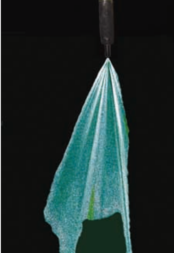
Şekil 8 Yakıt demeti ve anormal püskürtme konisi formu
