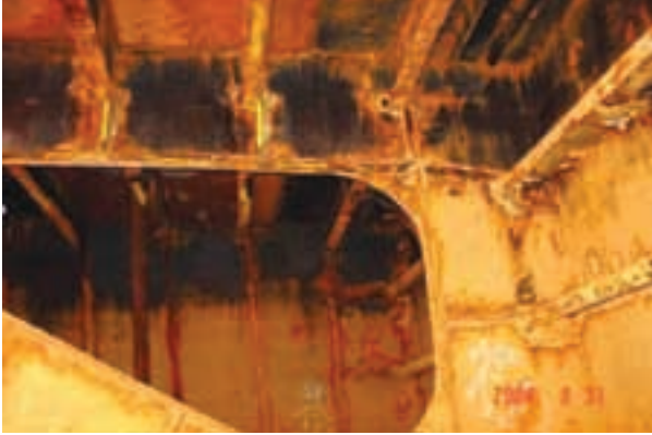
Şekil 3.3 Birleşim yerlerinde Korozyon
